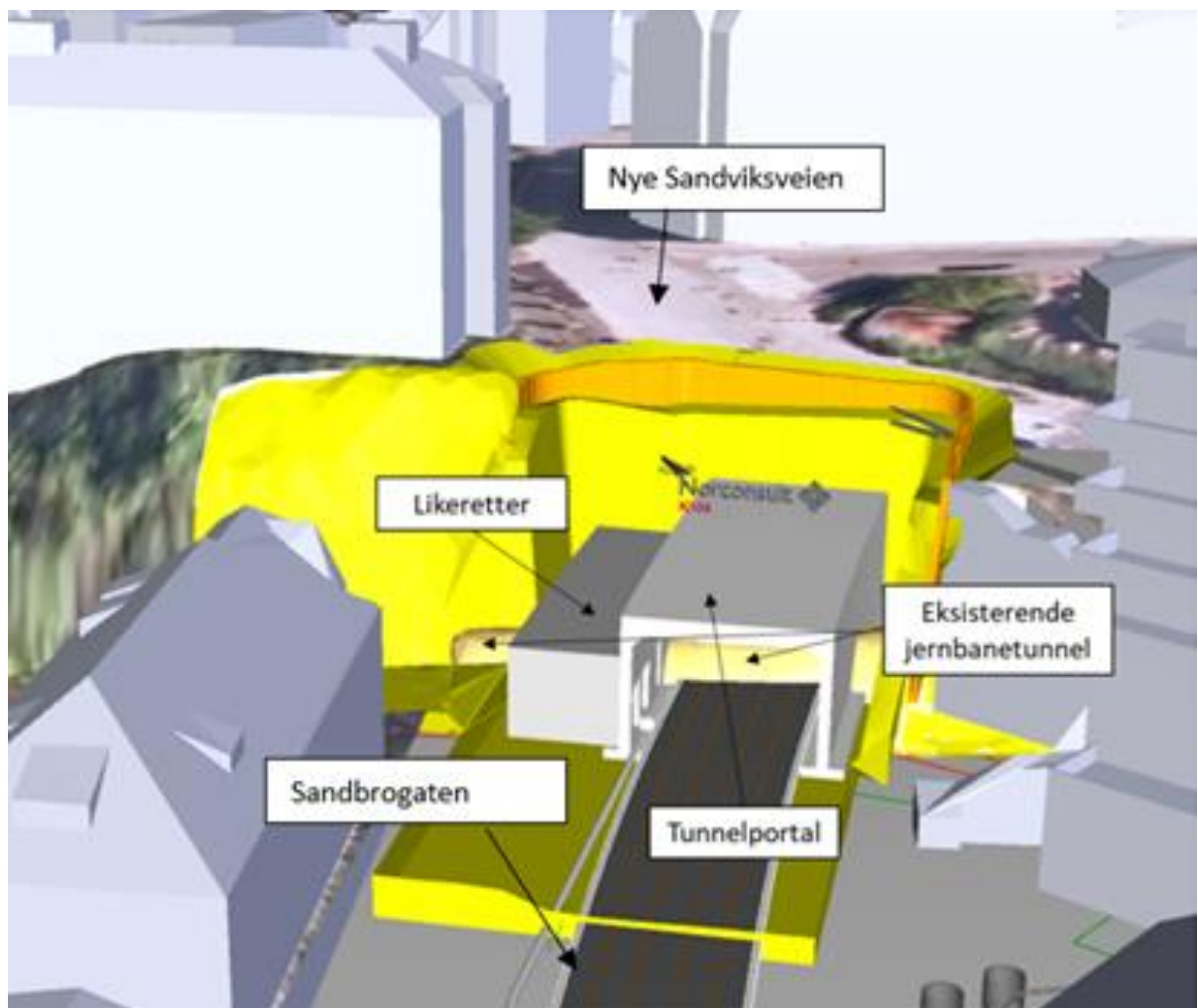
Figur 4 Skisse over påhugg til DS2 inn under Nye Sandviksveien.
