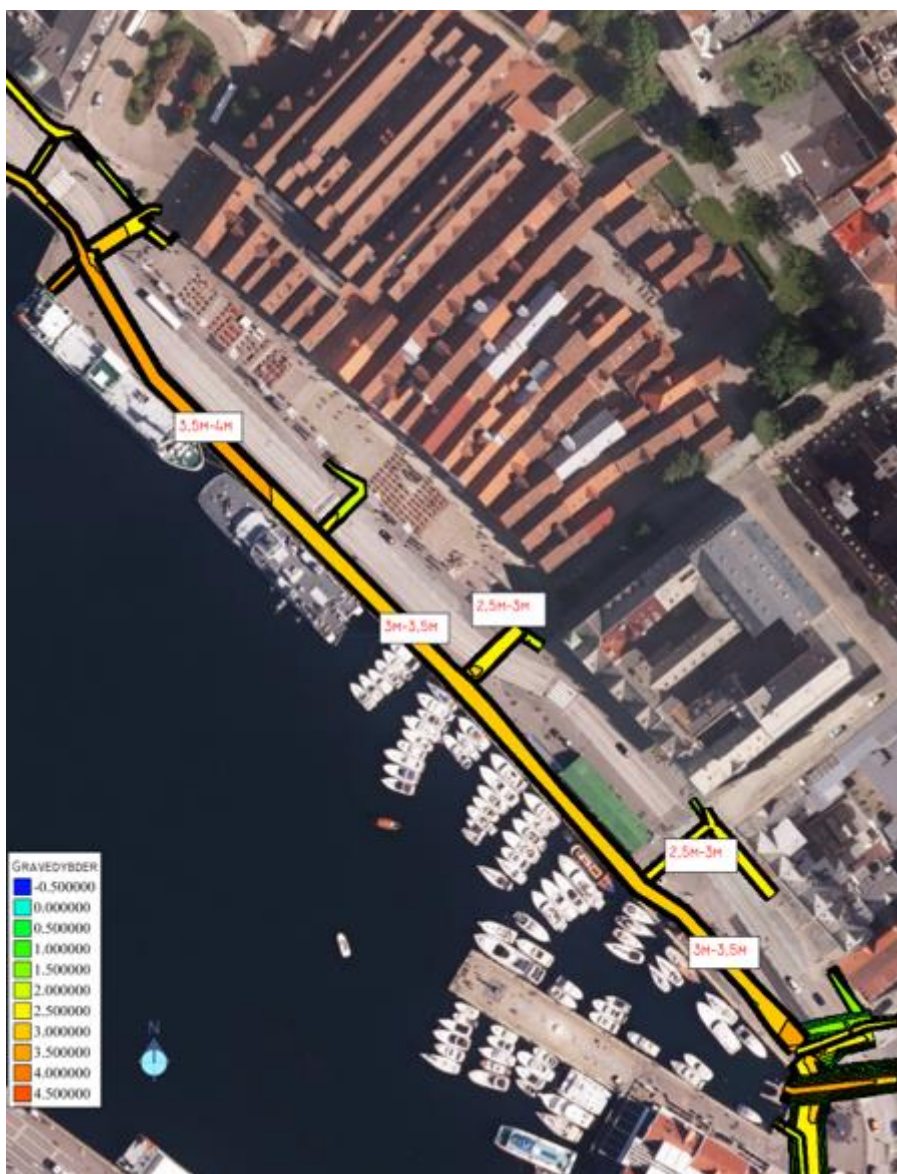
Figur 2 Flyfotoet viser grovt den planlagte grøftetrase for infrastruktur langs bryggen utenfor vei og nær kaifront. Bybanesporet vil plasseres på innsiden av kulverten nær den ytre del av nåværende kjørebane
